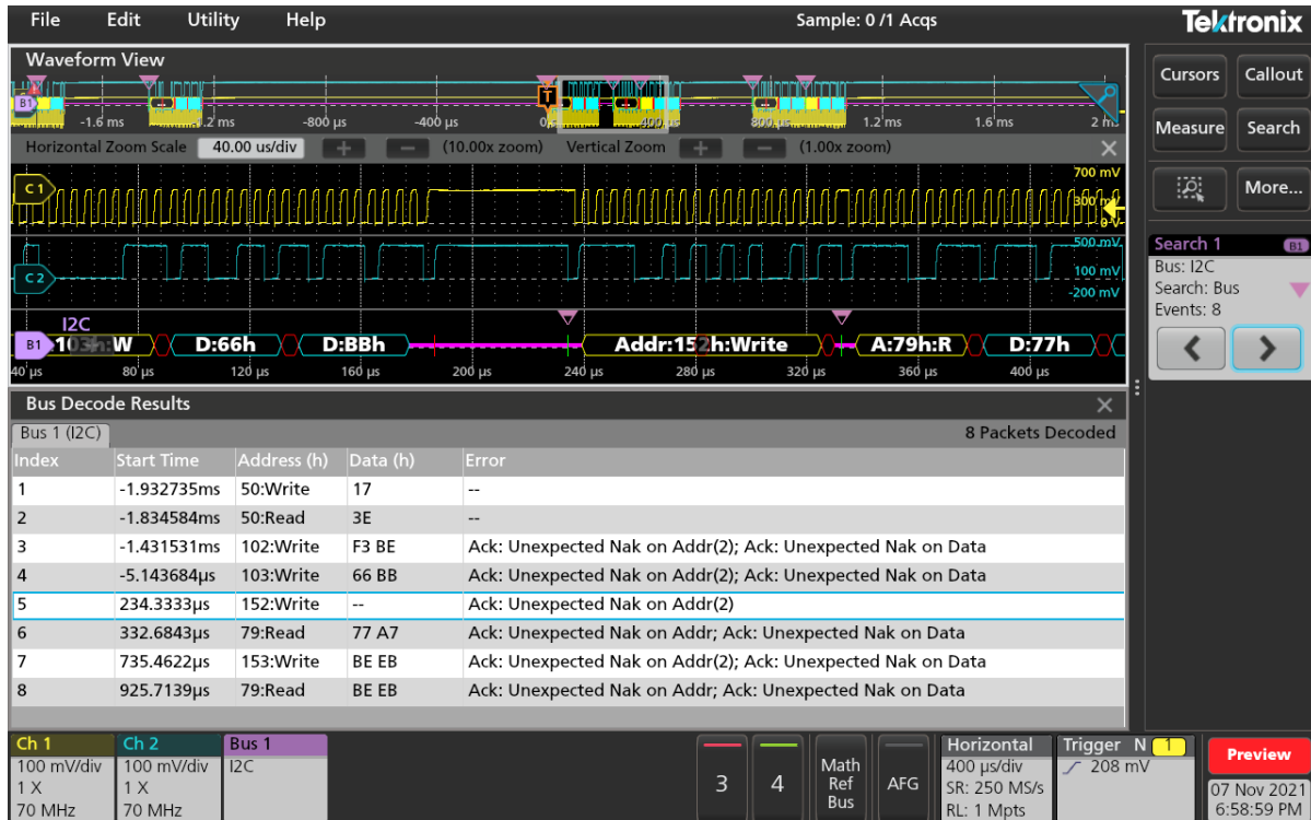
总线波形提供与时间相关的解码包，而总线解码表则显示整个采集中的所有数据包，可使用搜索功能进行导航
