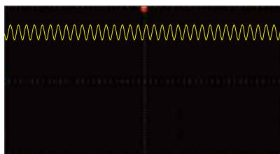
DC+AC Vdc=50V, sine 波形纹波 Vac=5V, 频率 1000Hz
