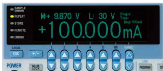
GS200的显示部分和操作键布局
