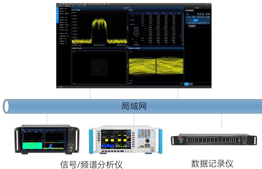
图 18 信号分析软件用于外场测试
