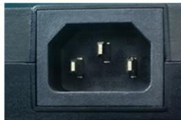
图 3.1 电源适配器电源插孔
