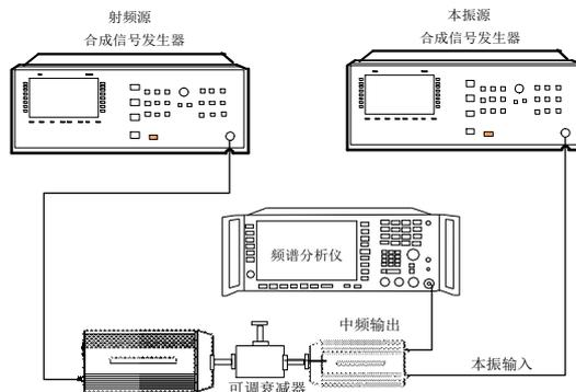
图 5.2 中频信号功率测试框图
