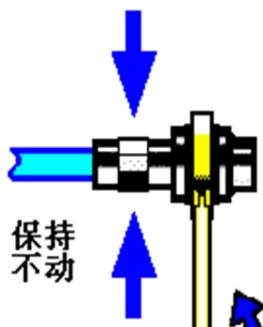
图 3.6 使用力矩扳手完成最后连接
