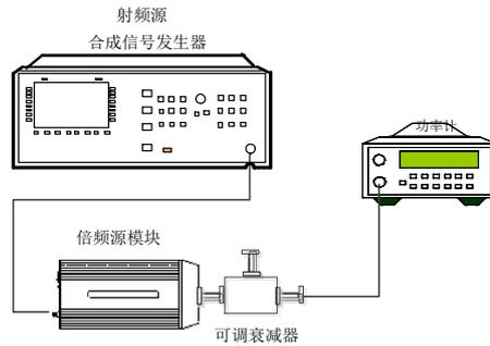
图 5.1 输入射频信号功率测试框图
