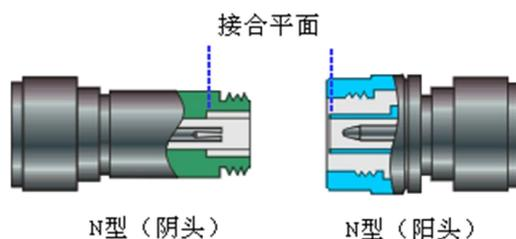
图 3.8 校准平面
