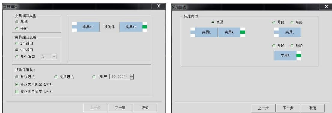
进行夹具的描述时，可以设置单端夹具及差分夹具，也可以选择夹具的端口数等信息。进行夹具参数的提取，需要对夹具标准进行测量。在标准描述界面，夹具标准包含三种类型：直通标准、开路标准、短路标准。
