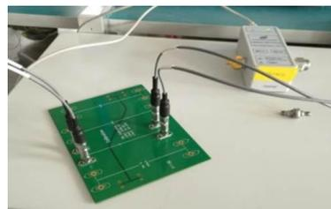
利用自动夹具移除功能，把被测件作为一个整体，进行平衡参数提取，并进行四端口的去嵌入。测试结果显示，传输参数能够很好的去除掉，同样近端串扰和远端串扰也得到有效去除。
