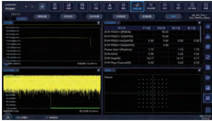
FR1-TM3-1-FDD-100MHz-60kHz实测结果
