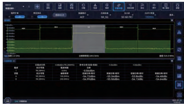
2GHz载波5G NR ACPR实测结果
