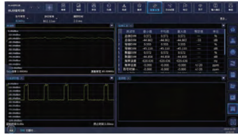
IEEE 802.11ax单用户PPDU信号解调EVM, 80MHz传输带宽, 1024QAM
