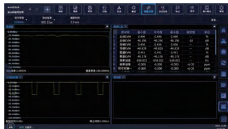
IEEE 802.11ac单用户PPDU信号解调EVM, 1600MHz传输带宽, QPSK+BPSK
