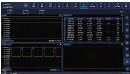
IEEE 802.11ax单用户PPDU信号解调EVM, 80MHz传输带宽, 256QAM
