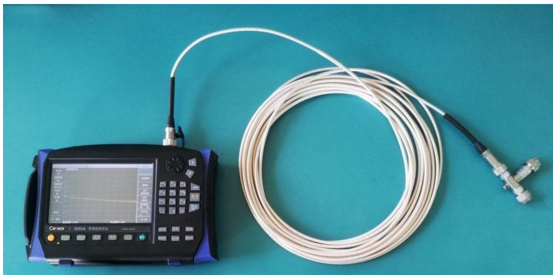
电缆损耗测试
